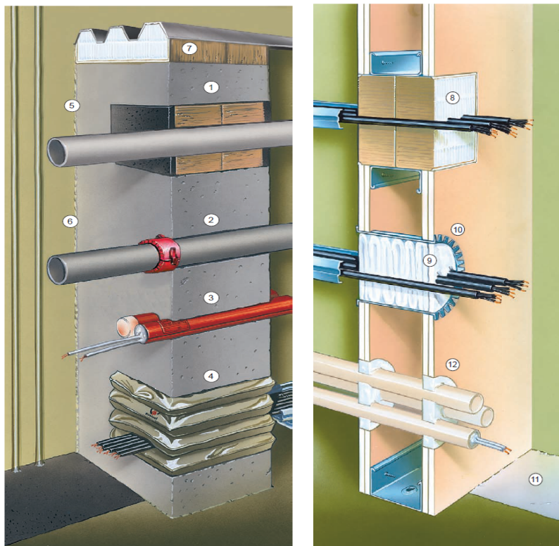
Rys. 2. Zabezpieczone przepusty instalacyjne
